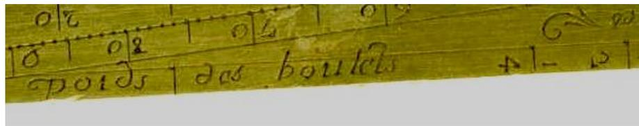
17 : Poids des boulets. Ligne gravée sur le bord extérieur du compas (B). Son origine est la graduation, discrètement située entre les mots "poids" et "des". Vers la droite, la première graduation est  $i = \frac{1}{4}$  livre, ensuite  $\frac{1}{2}$ , etc.
